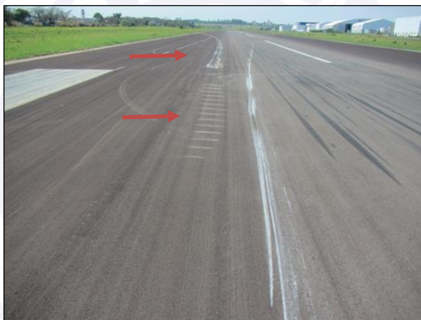
Figura 6 - Marcas deixadas pelo contato do leme, da hélice, do capô do motor, do spinner e da asa direita com a pista.
