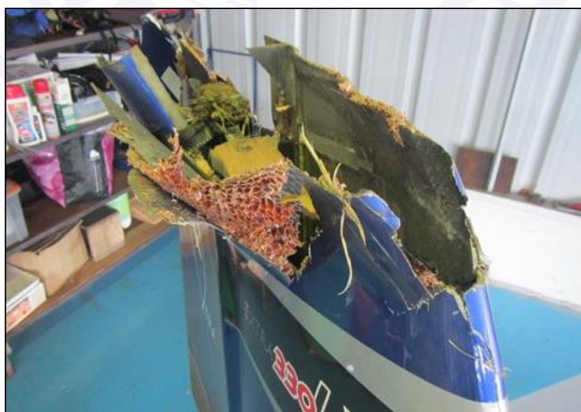
Figura 1 - Danos ao estabilizador vertical e leme.
