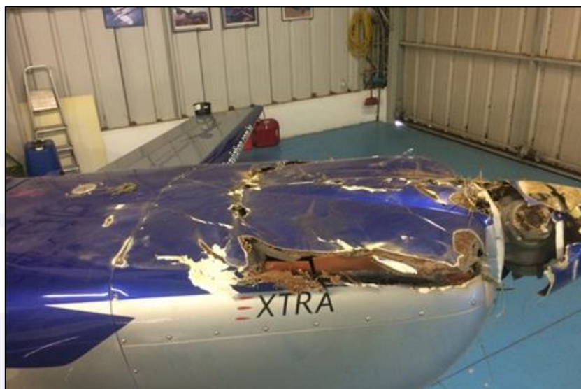
Figura 2 - Danos ao capô do motor, ao spinner e à hélice.
