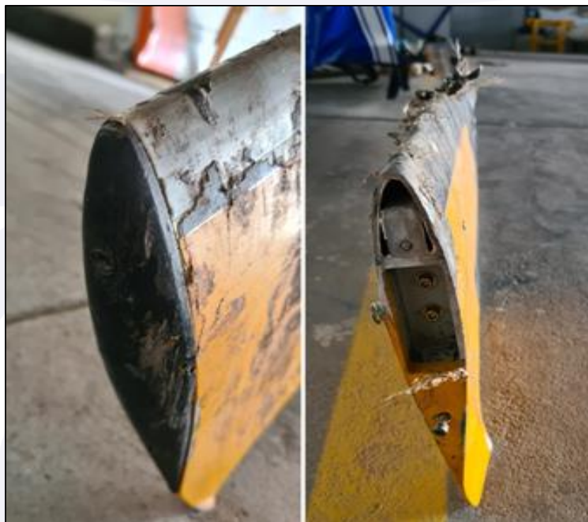
Figura 3 - Vista das pontas das pás do rotor principal com uma delas danificada pelo impacto contra o cone de cauda.
