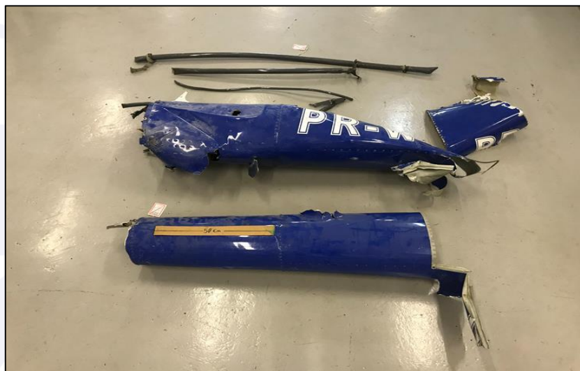
Figura 5 - Cone de cauda e árvore de comando traseira da aeronave PR-WVV.
