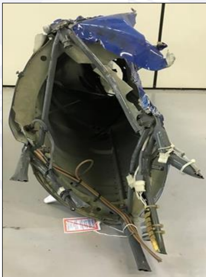
Figura 6 - Detalhe da superfície com fratura característica de falha a partir de sobrecarga.
