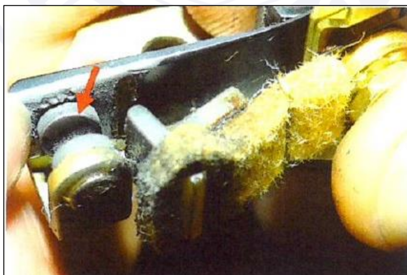
Figura 12 - Carbonização observada nos contatos do platinado do magneto esquerdo do motor.
