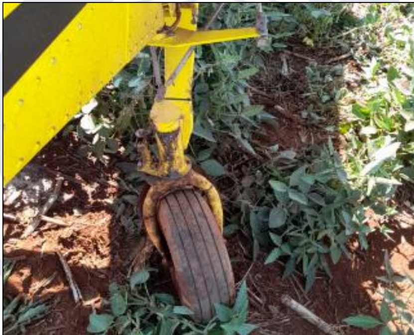
Figura 3 - Detalhe da bequilha desalinhada.
