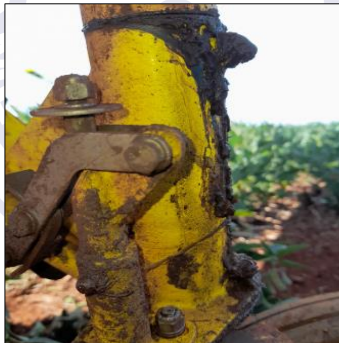
Figura 5 - Acúmulo de sujeira no conjunto de travamento da bequilha.
