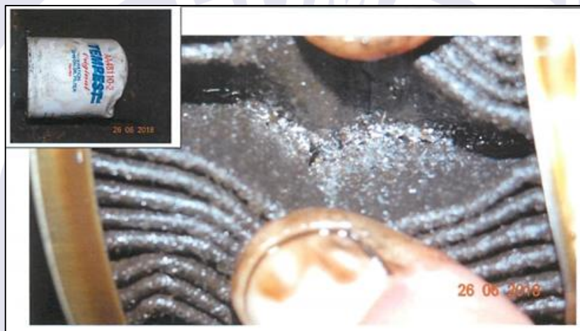
Figura 3 - Presença de limalha no filtro de óleo.
