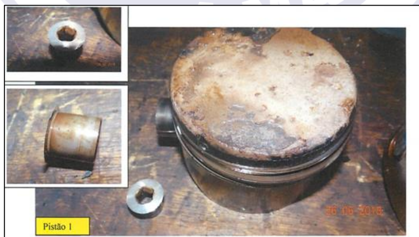
Figura 4 - Desgaste no “plug” do pistão do cilindro número 1.
