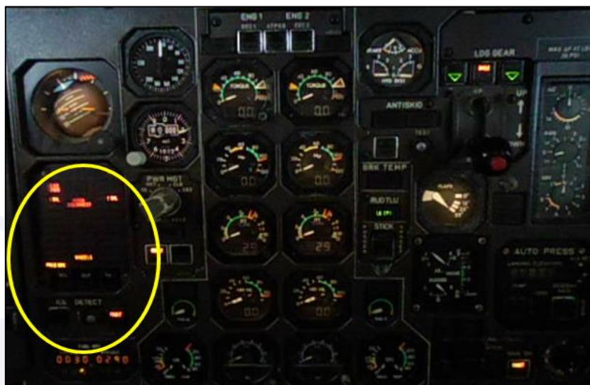
Figura 25 - Indicações mostradas no painel da aeronave após a ocorrência (destacado).
