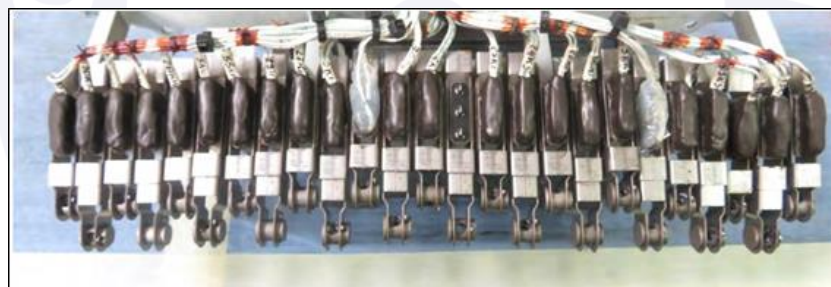
Figura 38 - Microswitches instaladas na Microswitch Box , PN 11S76180650-010, SN 0199.
