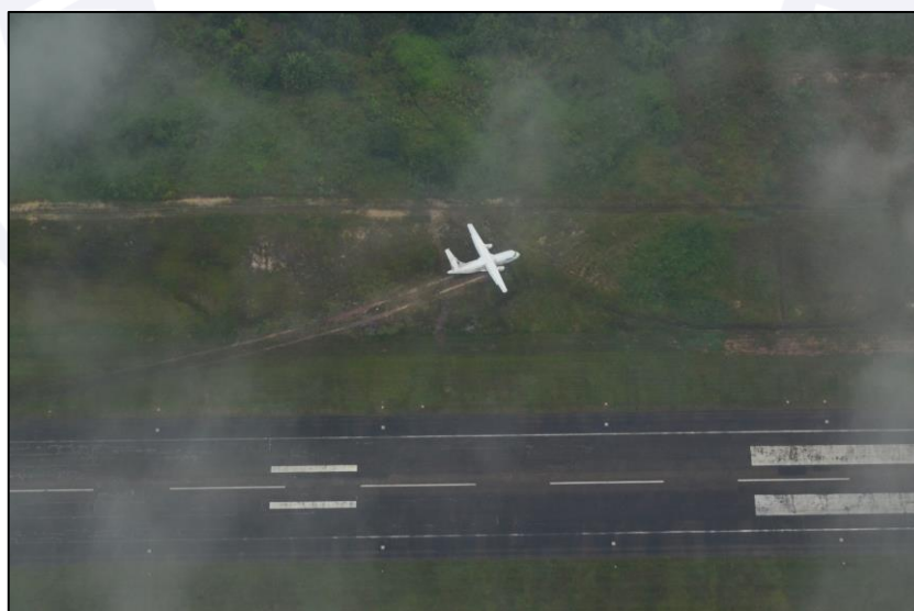
Figura 24 - Vista de cima da trajetória percorrida pela aeronave no solo.
