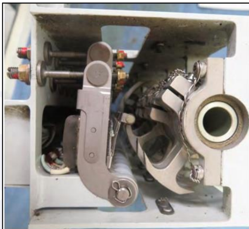
Figura 37 - Vista lateral esquerda da desmontagem da Microswitch Box .
