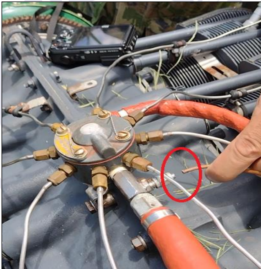
Figura 2 - Detalhe da tubulação rompida na linha de pressão principal.
