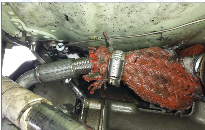
Figura 03 - Mangueira da bomba hidráulica do motor direito danificada.
