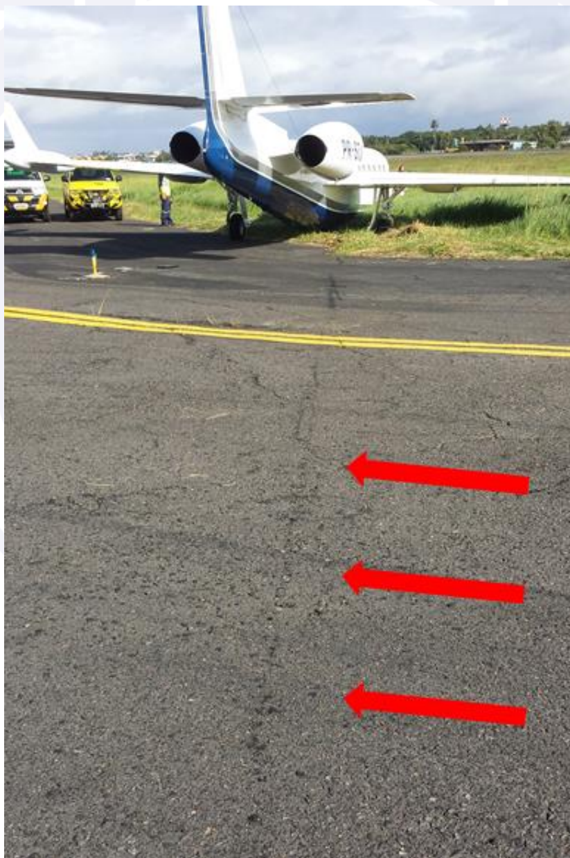
Figura 01 - Marcas do fluido hidráulico da aeronave na pista de táxi.
