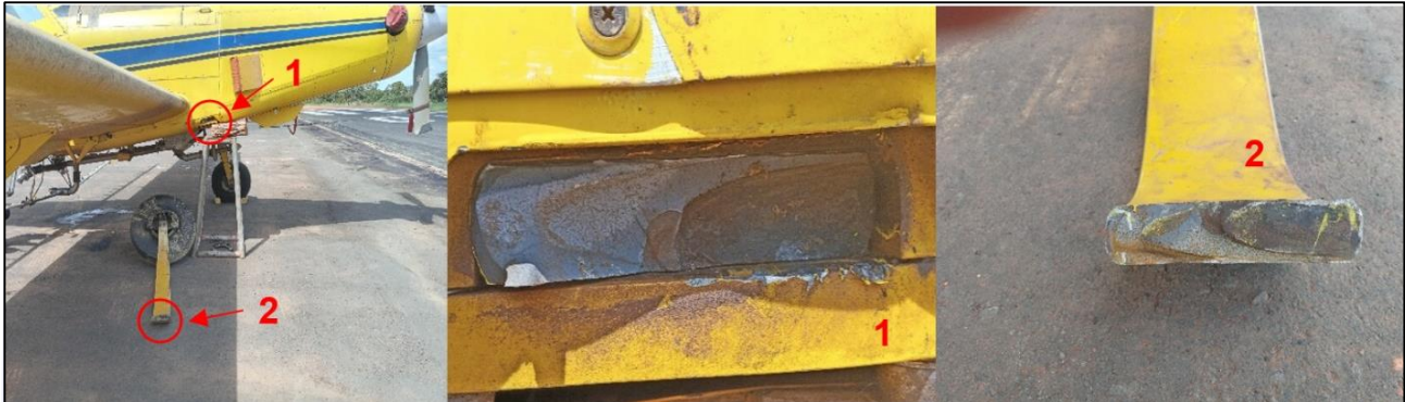
Figura 2 - Trem de pouso avariado e o local da ruptura.
