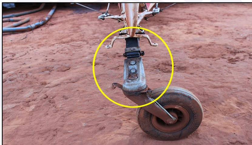
Figura 6 - Trem de pouso auxiliar, com destaque para a ausência das molas de conexão ao leme de direção.
