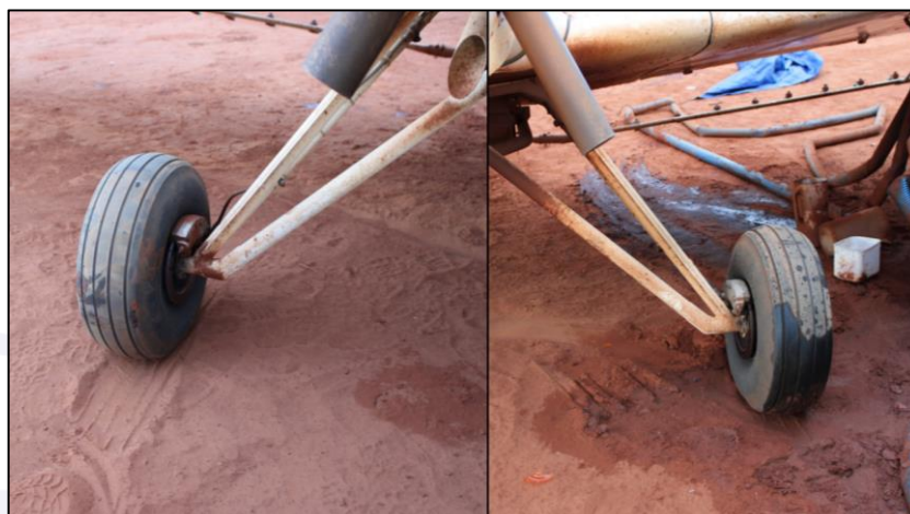
Figura 5 - Pernas do trem de pouso principal, rodas e freios.
