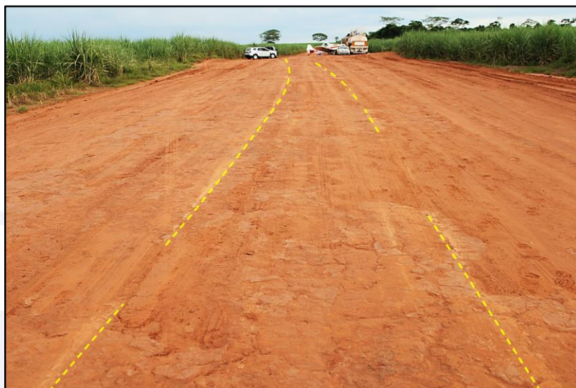
Figura 8 - Marcas de frenagem deixadas pela aeronave nos instantes que antecederam a colisão contra o veículo, destacadas pelas linhas pontilhadas.
