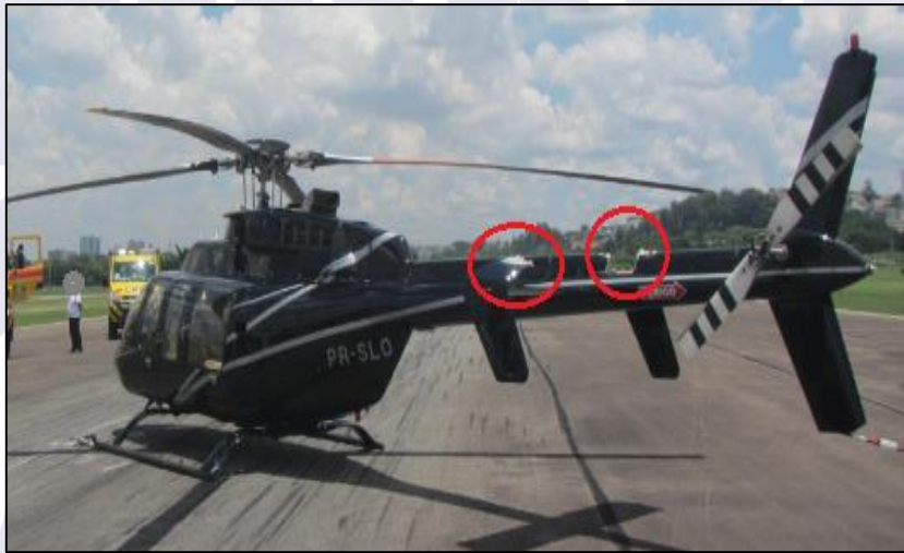
Figura 1 - Vista do PR-SLO no local do acidente, com destaque para os danos no eixo de acionamento do rotor de cauda e no estabilizador horizontal.
