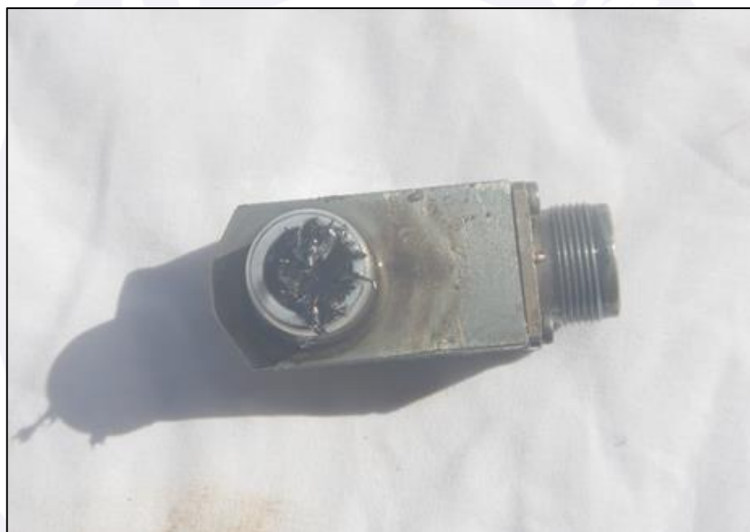
Figura 10 - Plug magnético do sistema de detecção de limalha do motor contaminado com partículas de metal.
