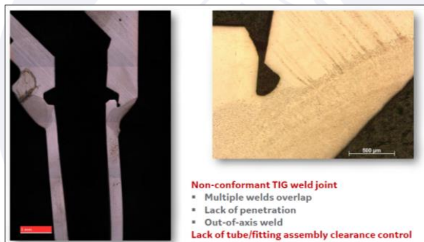
Figura 15 - Imagem colhida durante o exame metalográfico do tubo seccionado destacando características de solda distintas das requeridas.
