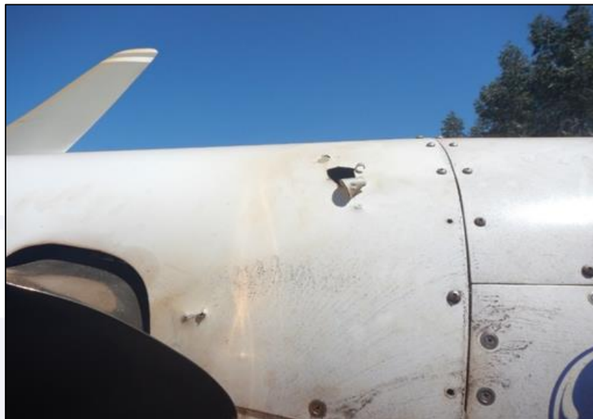
Figura 6 - Dano com perfuração do lado esquerdo da carenagem do motor.
