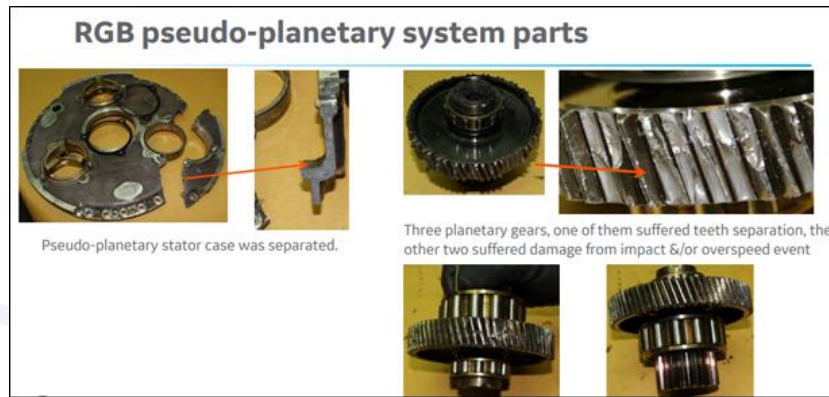
Figura 16 - Engrenagens planetárias danificadas. Fonte: Investigation Report GEAC.
