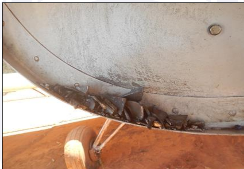
Figura 7 - Detritos encontrados na parte interna do compartimento do motor.
