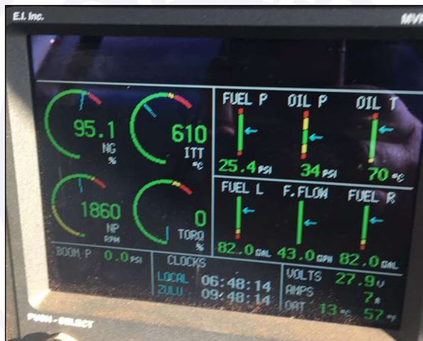
Figura 27 - Imagem registrada pelo PIC mostrando a indicação de torque na tela do MVP-50T.
