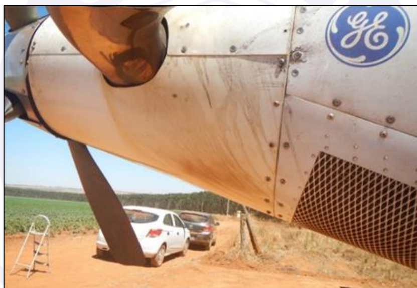
Figura 5 - Marcas de óleo na carenagem do motor.
