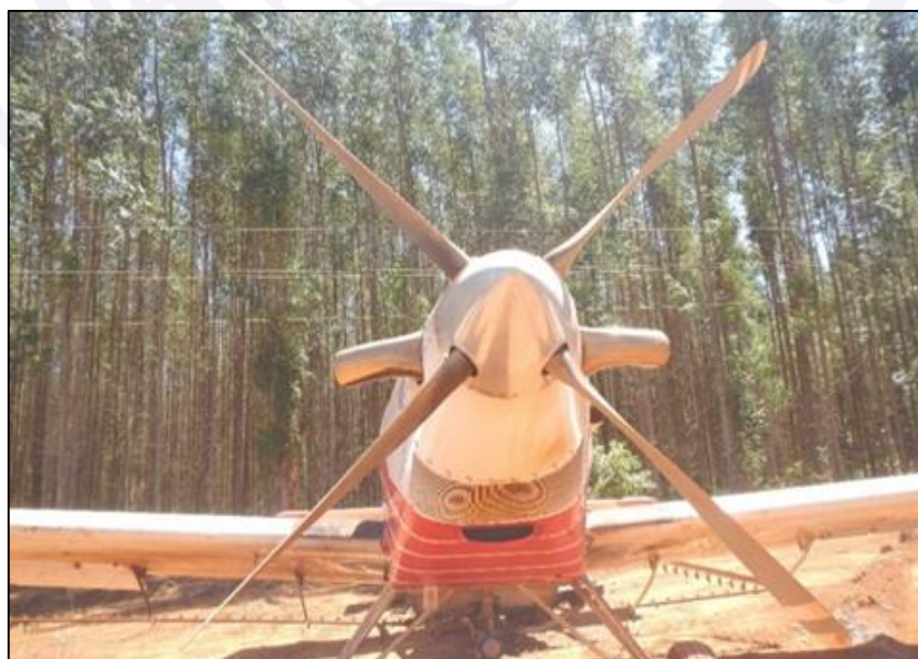
Figura 4 - Imagem da hélice da aeronave com as pás na posição de passo bandeira.
