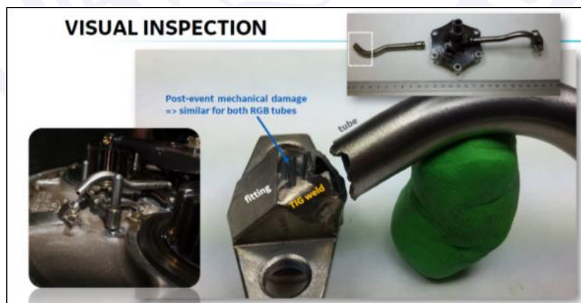
Figura 13 - Imagens da RGB Oil Tube fraturado colhidas durante a desmontagem do motor. Fonte: Investigation Report GEAC.
