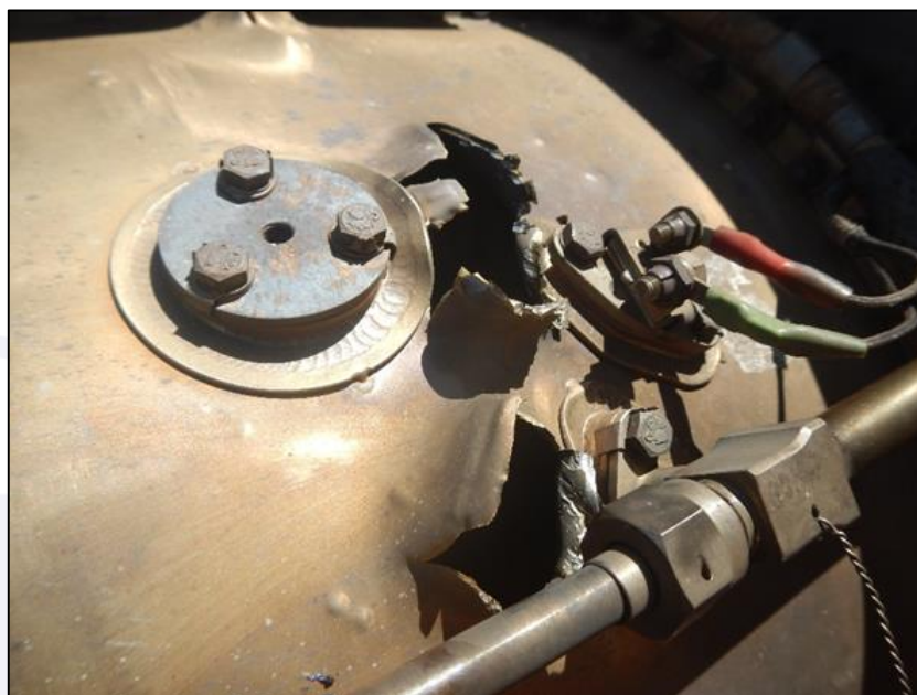
Figura 9 - Evidências de danos internos severos no motor.
