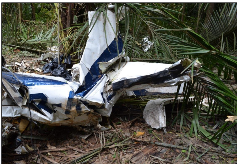
Figura 7 - Cauda da aeronave sem leme e profundor. A violência do impacto contra o solo pode ser identificada pelo amassamento e torção de parte da fuselagem observada na foto.
