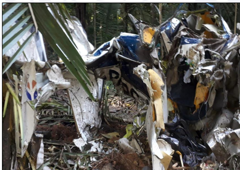
Figura 6 - Posição da aeronave após a parada total. Sem asas e com a cabine destruída.
