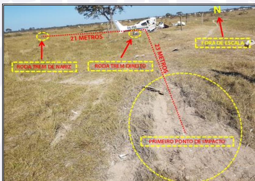
Figura 2 - Primeiro ponto de impacto e distribuição dos destroços.
