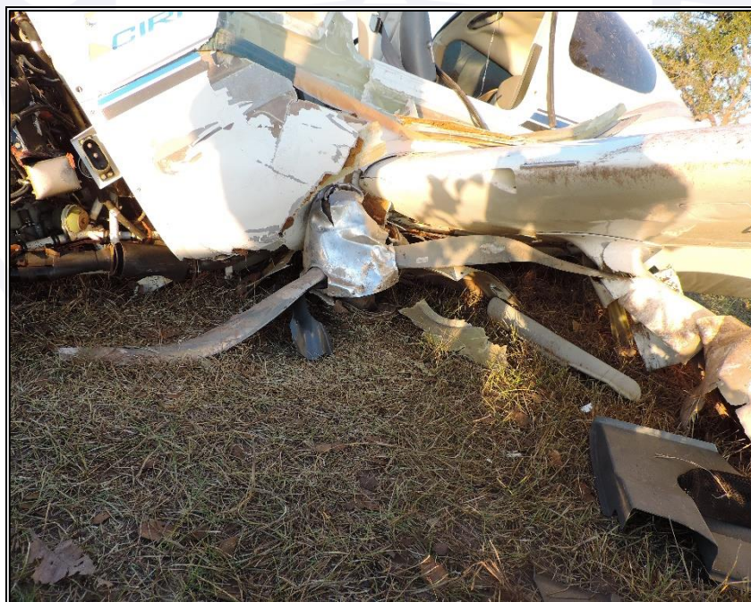
Figura 5 - Conjunto de hélice desprendido e encontrado embaixo da fuselagem, com dobramento nas pás.
