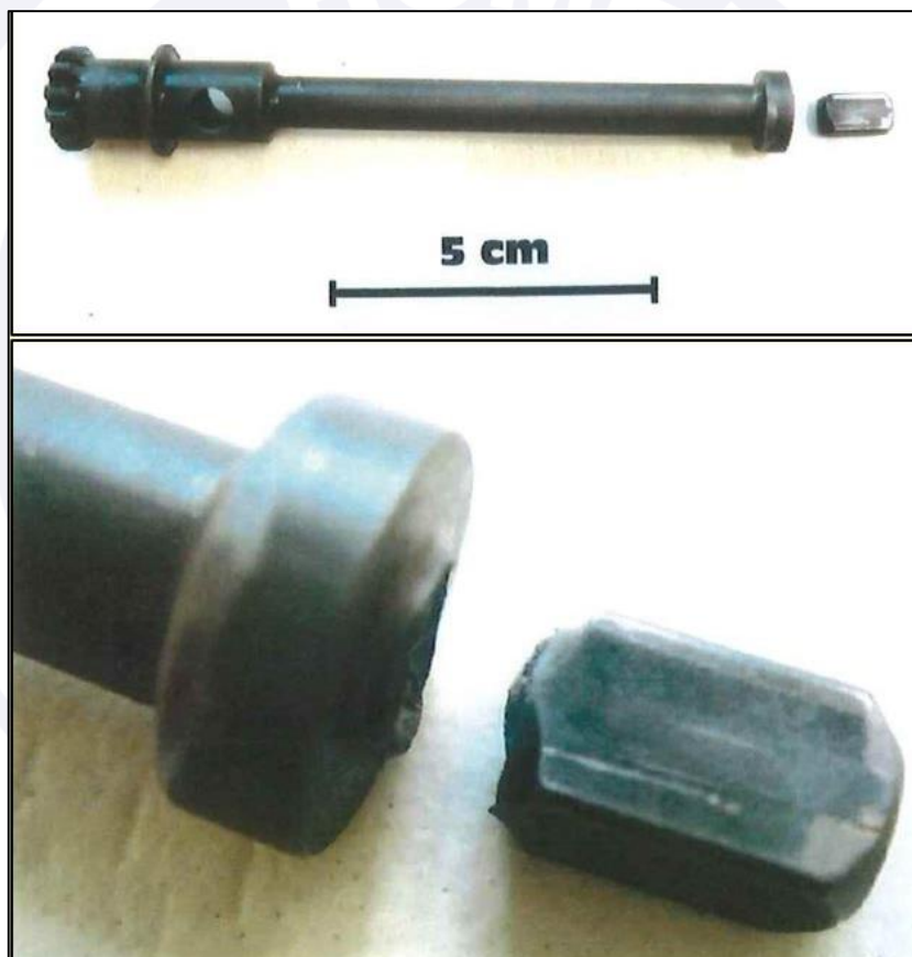
Figura 9 - Eixo de acionamento da bomba de combustível do motor com fratura em sua extremidade.
