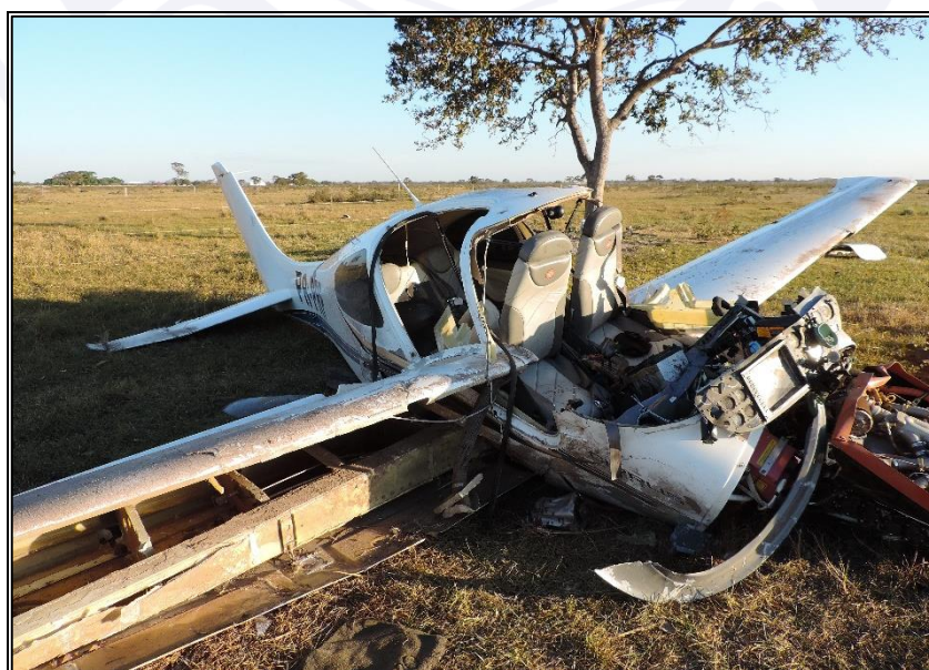
Figura 3 - Vista geral dos destroços. Cabine e asa direita destruídas.
