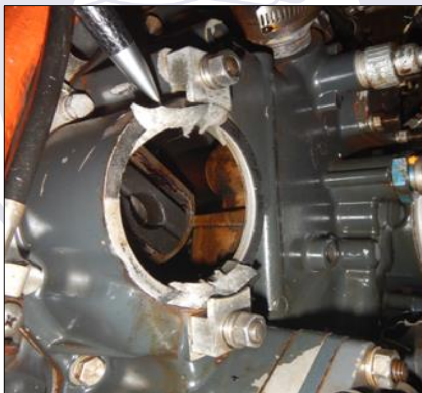
Figura 3 - Fratura na base do magneto.
