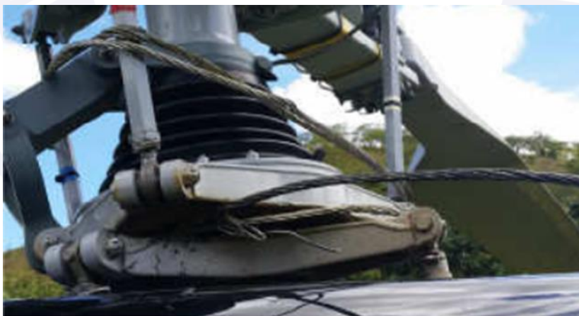
Figura 6 - Cabo elétrico preso aos componentes do rotor principal.
