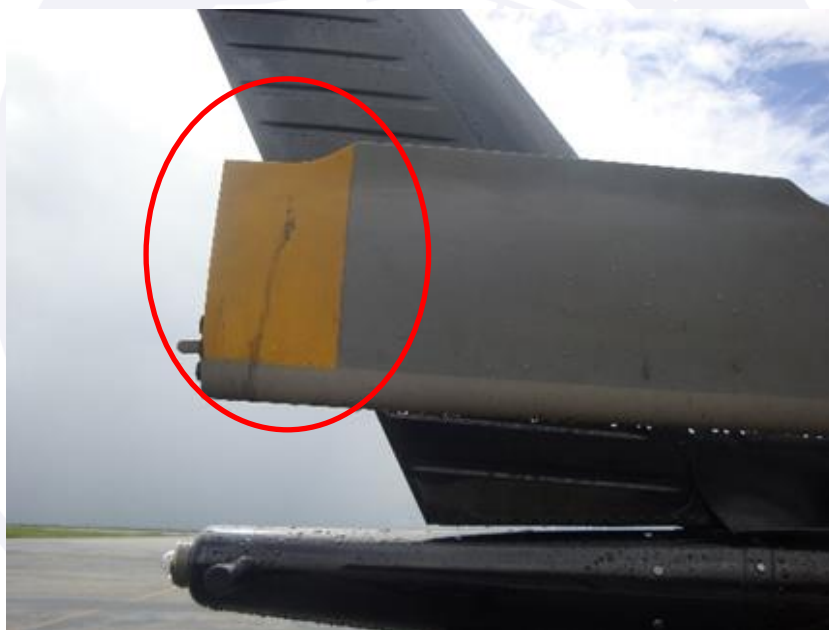
Figura 2 - Danos em uma das pás do rotor de cauda.
