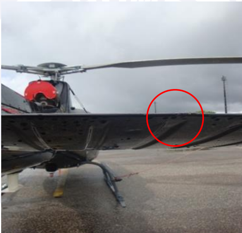
Figura 4 - Danos no estabilizador horizontal.
