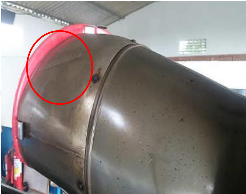
Figura 3 - Danos no escapamento do motor.
