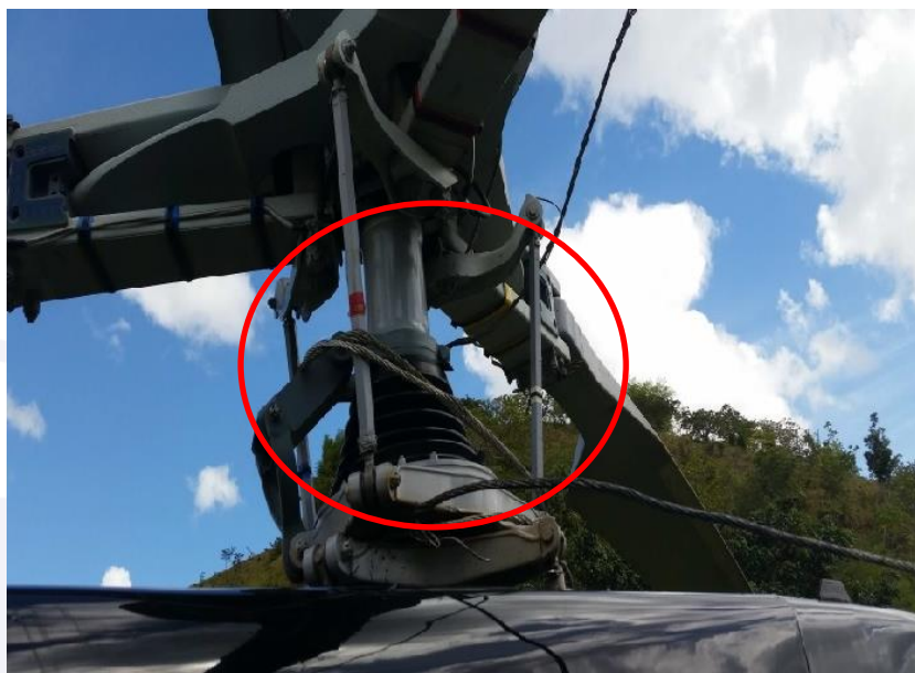
Figura 1- Danos no conjunto do rotor principal
