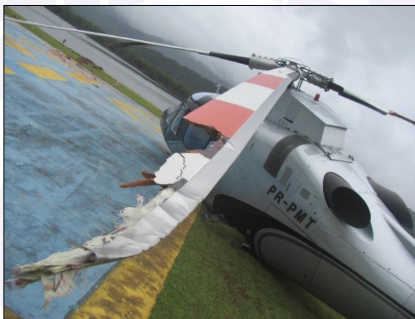
Figura 7 - Vista dos danos às pás do rotor principal.
