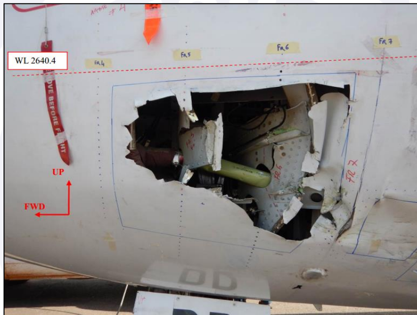
Figura 4 - Perfurações no Skin Panel dianteiro esquerdo. Fonte: ATR.
