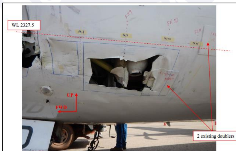
Figura 5 - Perfurações no Skin Panel dianteiro esquerdo. Fonte: ATR.
