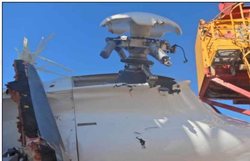
Figura 2 - Vista da cabeça do rotor principal sem as pás.
