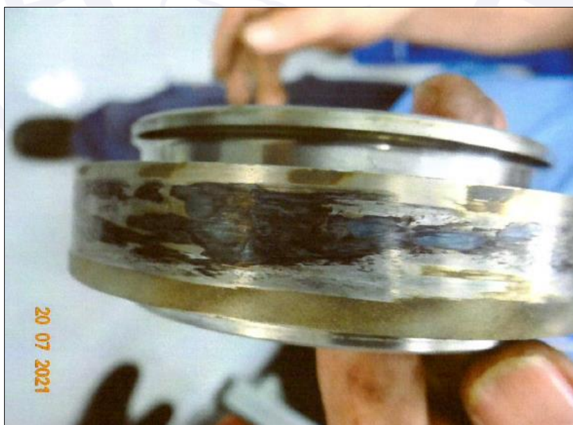
Figura 3 - Marcas de roçamento observadas no espaçador entre o 1º e 2º estágios de compressão.
