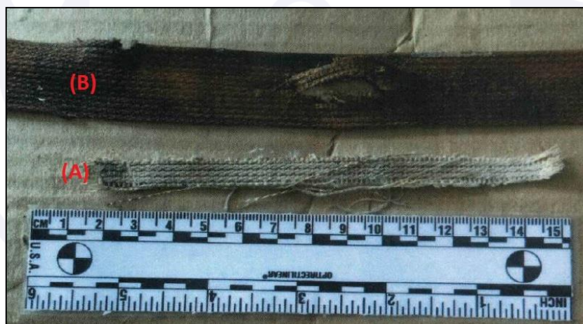
Figura 7 - (A) tecido encontrado no carburador - (B) tecido da fuselagem da aeronave.
