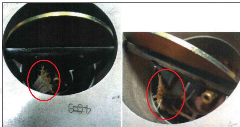
Figura 6 – Imagens do material estranho preso no venturi do carburador.
