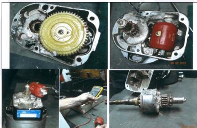
Figura 11 - Imagens dos exames e testes realizados no magneto esquerdo.
