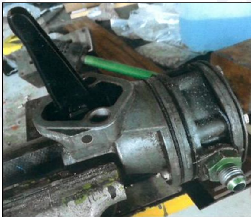
Figura 9 - Vista da bomba de combustível.
