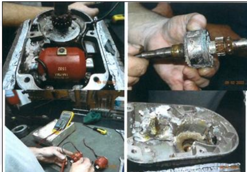
Figura 10 - Imagens dos exames e testes realizados no magneto direito.
