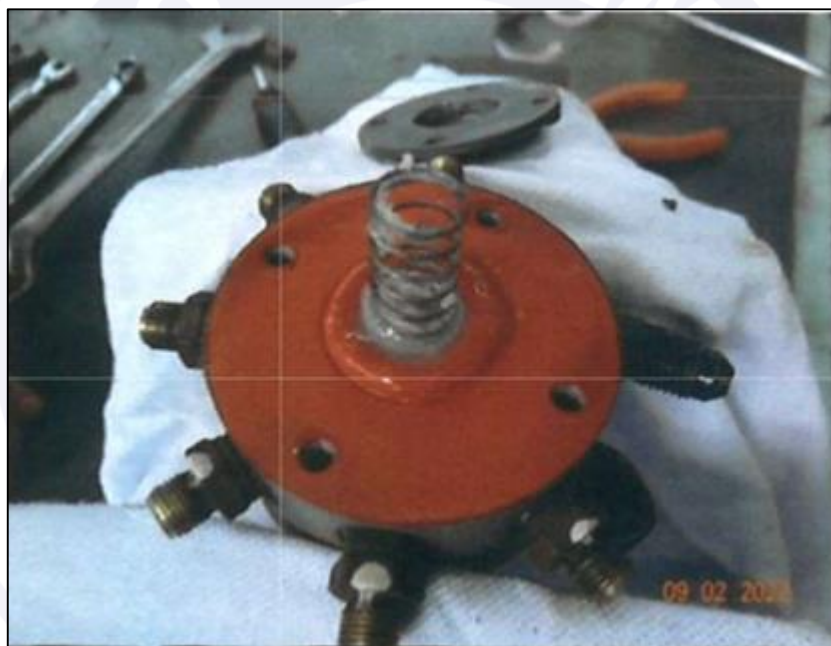
Figura 7 - Vista do diafragma da distribuidora de combustível com água salgada e corrosão na sua mola.
