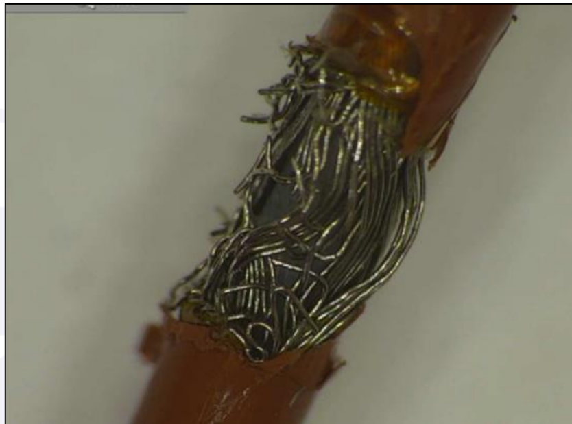
Figura 11 - Proteção da cablagem encontrada danificada. Fonte: Relatório de Investigação da SAFRAN.
