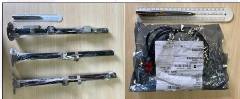
Figura 10 - Fuel probes e cablagem da probe # 3 enviados para testes.
