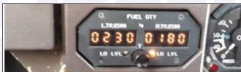
Figura 23 - Fuel LO LVL do Eng#2 do PR-MPY acesa em SBIH.
