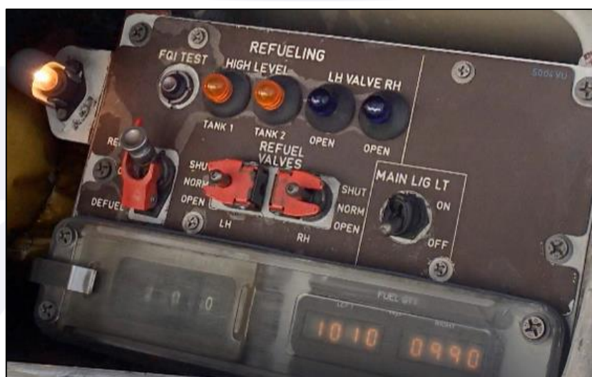
Figura 25 - Refuel Control Panel do ATR-72 (imagem ilustrativa). Fonte: ATR Systems - Fuel System.
