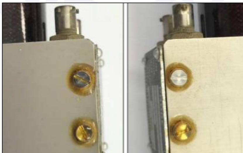
Figura 17 - Verniz nos parafusos da caixa elétrica do fuel probe PN 768-100, SN 516. Fonte: Relatório de Investigação da SAFRAN.
