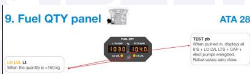
Figura 5 - Luz de advertência de baixo nível na cor âmbar. Fonte: ATR Training & Flight Operations Services.
