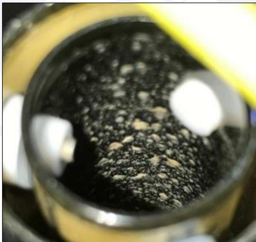
Figura 14 - Poluição no interior do fuel probe PN 768-100, SN 1358.
