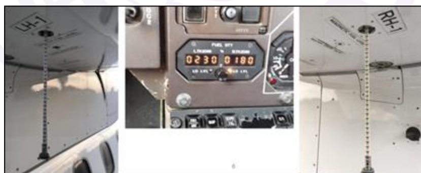
Figura 9 - Indicação do FQI e dos Fuel Level Magnetic Indicators do PR-MPY medidos após o pouso em SBIH.
