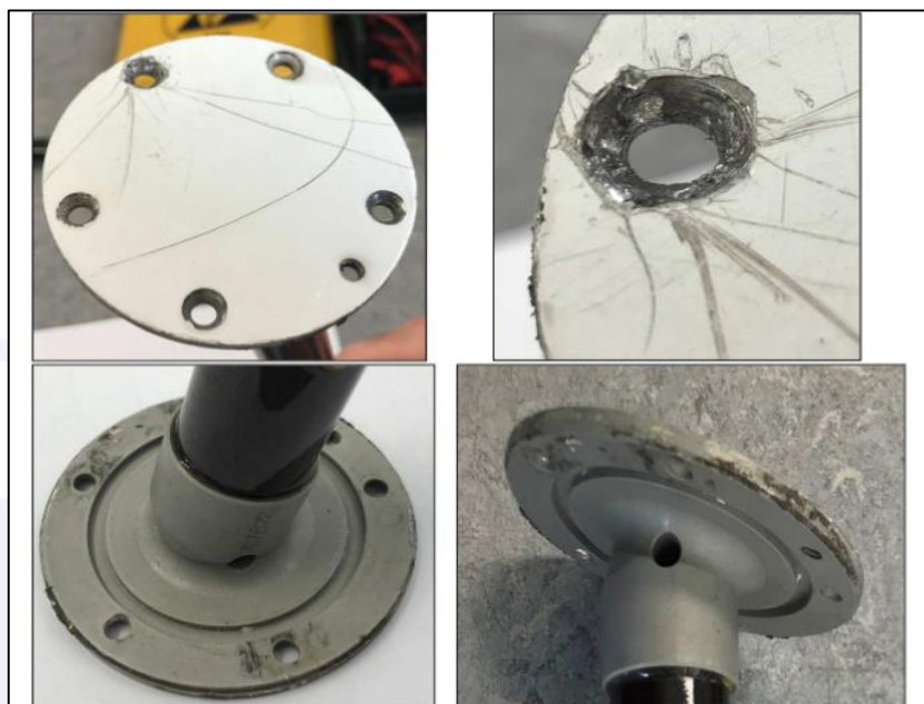
Figura 15 - Danos na cabeça do fuel probe PN 768-100, SN 516 7. Fonte: Relatório de Investigação da SAFRAN.
