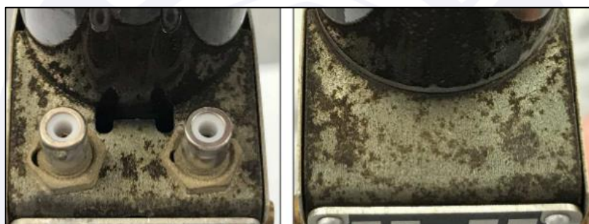
Figura 16 - Oxidação na caixa elétrica do fuel probe PN 768-100, SN 516 7. Fonte: Relatório de Investigação da SAFRAN.
