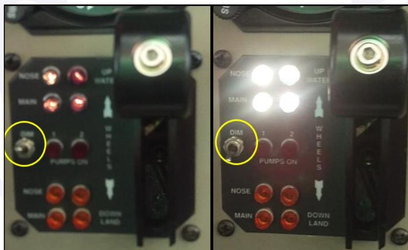
Figura 10 - Diferença de intensidade das luzes. Posição DIM à esquerda e NORMAL à direita.
