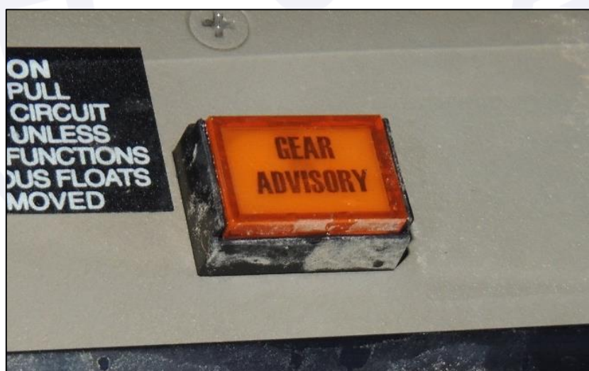
Figura 4 - Botão Gear Advisory instalado na aeronave PR-MPE.
