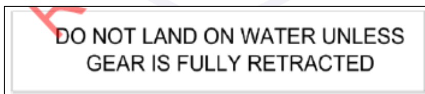
Figura 15 - Placard de aviso sobre o trem de pouso para pouso na água.
