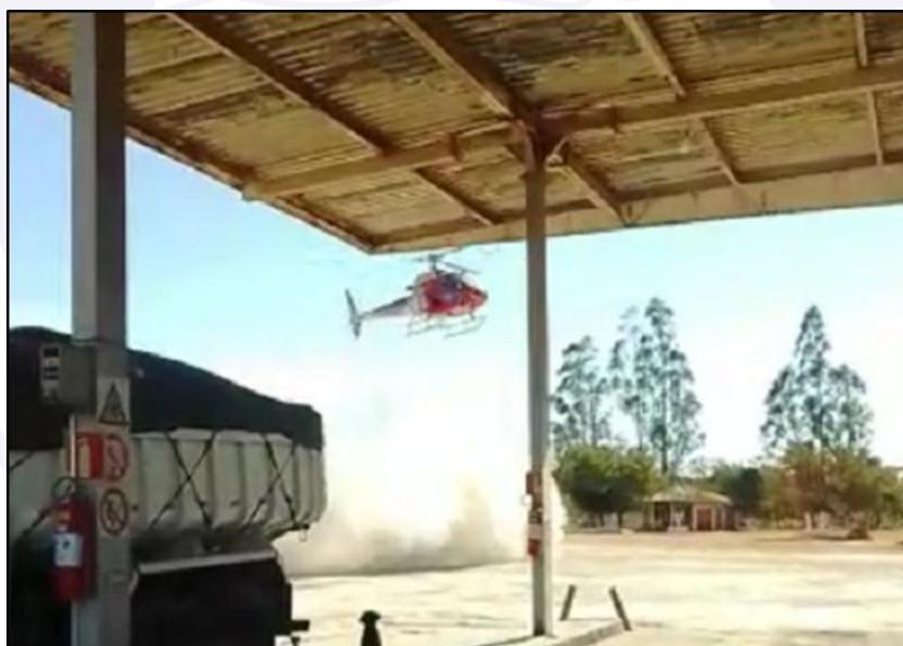
Figura 40 - Levantamento de partículas na área de pouso pelo *downwash* do rotor principal.
