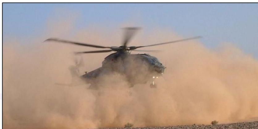
Figura 23 - Helicóptero entrando em uma condição de *brownout*.
