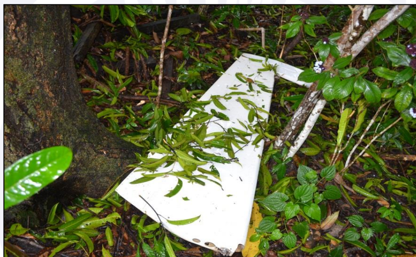
Figura 2 - Profundor esquerdo encontrado próximo ao local do primeiro impacto.
