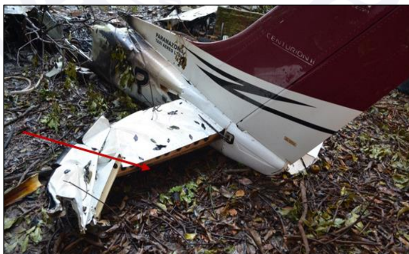
Figura 3 - Estabilizador horizontal esquerdo sem profundor.
