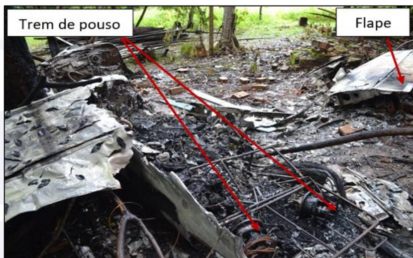
Figura 4 - Aeronave destruída pelo fogo. Trem de pouso e flapes recolhidos.
