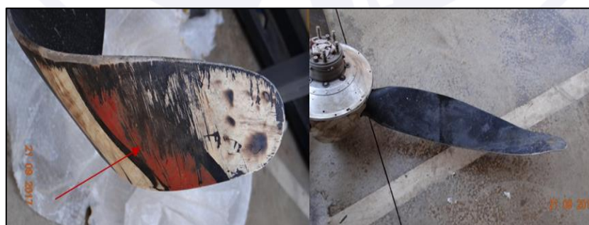
Figura 13 - Riscos e amassamento das pás da hélice.
