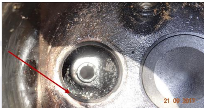
Figura 6 - Sede da válvula com coloração escura.
