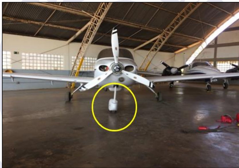
Figura 1 - Aeronave no hangar da organização de manutenção com detalhe do empeno do trem de pouso do nariz.
