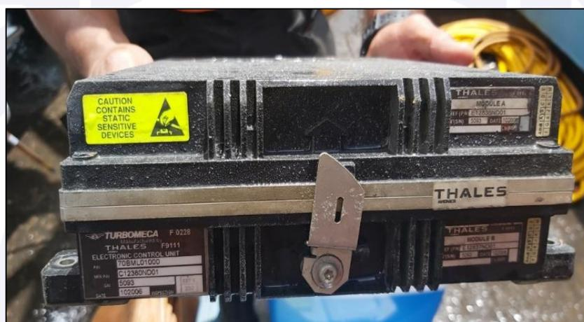
Figura 3 - Digital Engine Control Unit do motor nº 1.
