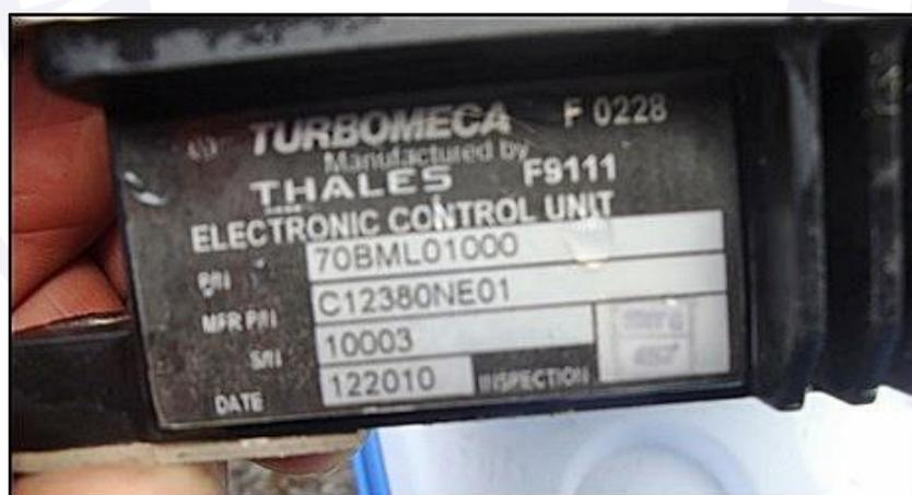
Figura 4 - Digital Engine Control Unit do motor nº 2.
