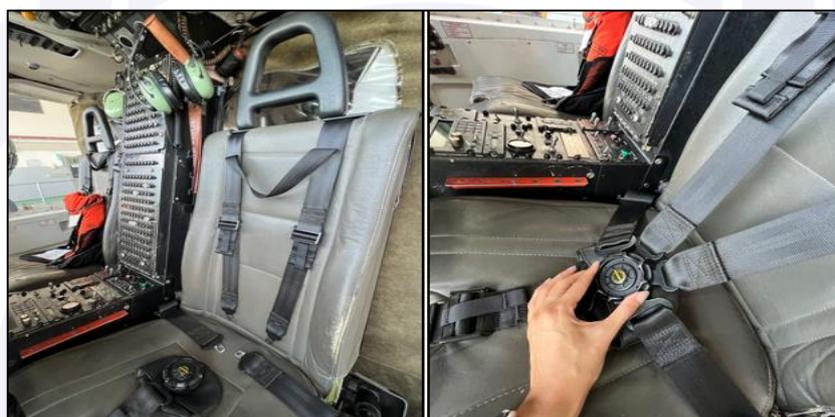
Figura 6 - Cinto de segurança do assento do posto de pilotagem esquerdo do S-76C++.
