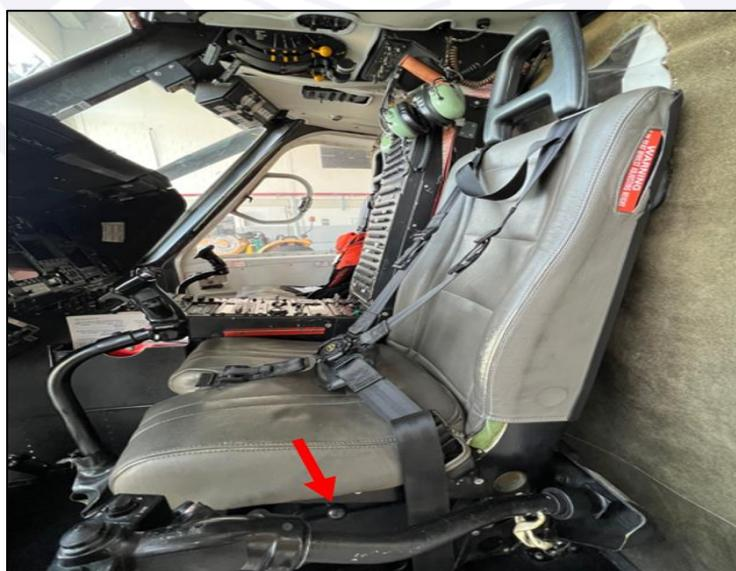
Figura 7 - Vista da alavanca de controle do carretel de inércia do assento do posto de pilotagem esquerdo do S-76C++.
