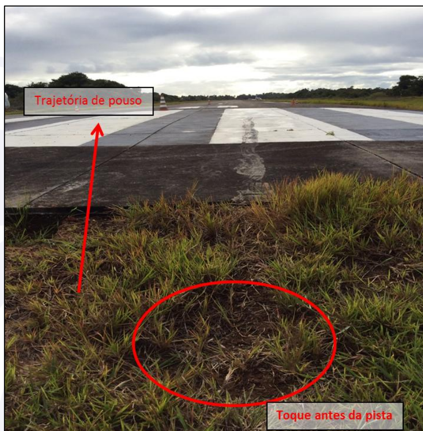
Figura 1 - Marcas do toque do trem de pouso principal direito antes do início da pista.
