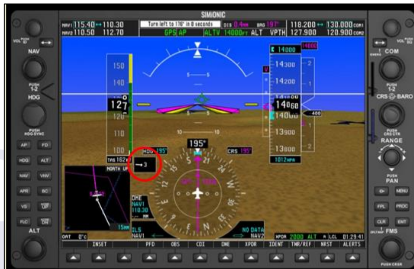
Figura 8 - Exemplo de tela do Primary Flight Display (PFD) da aeronave, com destaque para a informação de direção e intensidade do vento.
