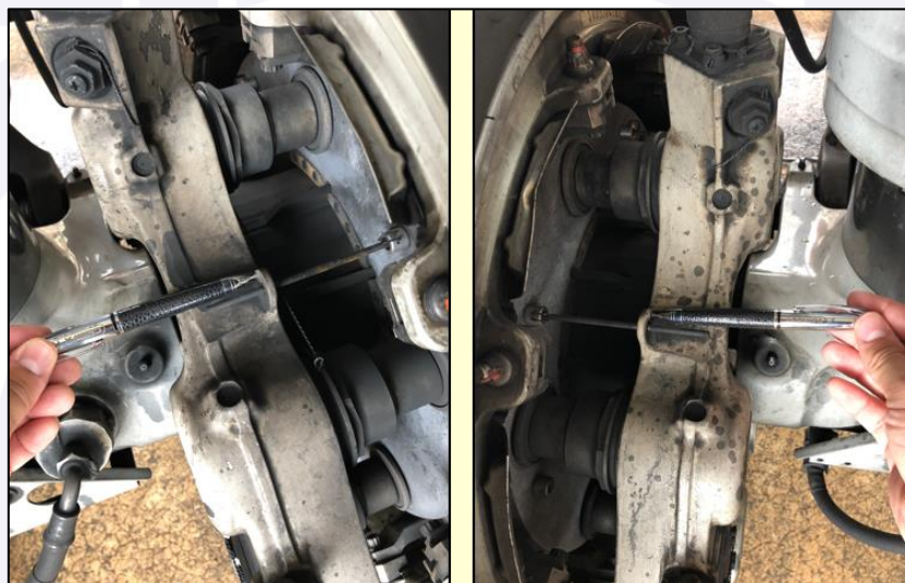
Figura 6 - Conjunto de freios do trem de pouso principal esquerdo (interno e externo).
