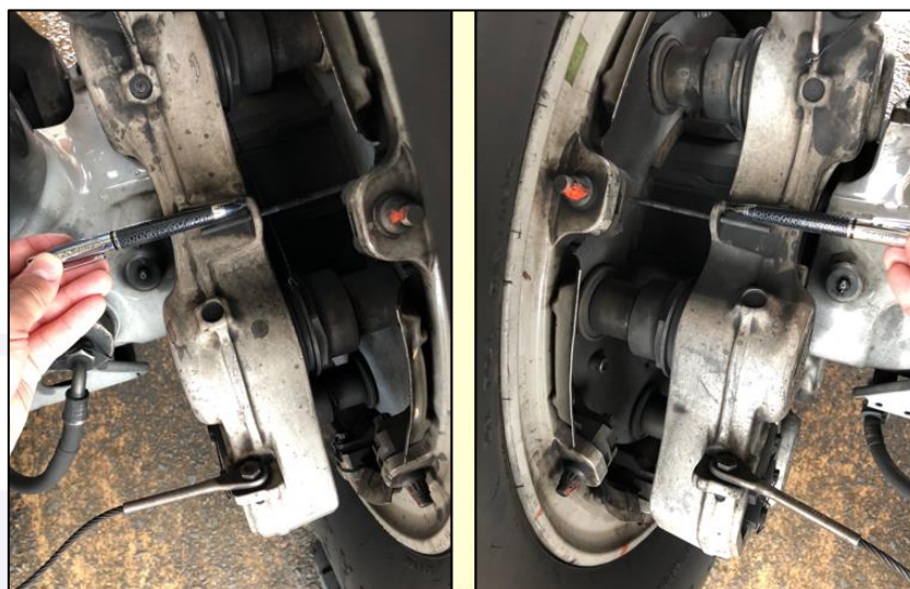
Figura 5 - Conjunto de freios do trem de pouso principal direito (interno e externo).
