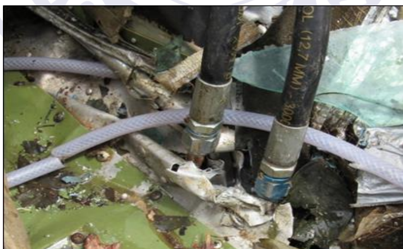
Figura 3 - Vista aproximada das mangueiras do sistema de combustível adaptado, com conexões irregulares e mangueiras hidráulicas não certificadas para uso na aviação.
