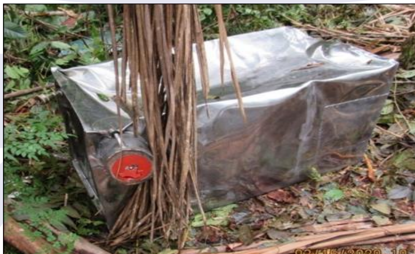
Figura 2- Vista aproximada do tanque de combustível que estava instalado internamente na aeronave (na foto ele aparece retirado do interior da aeronave).
