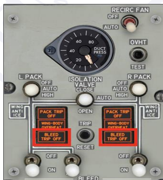
Figura 7 - Painel de pressurização, com destaque para as luzes BLEED TRIP OFF. Fonte: FCOM.
