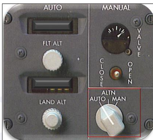
Figura 10 - Modos de controle de pressurização.
