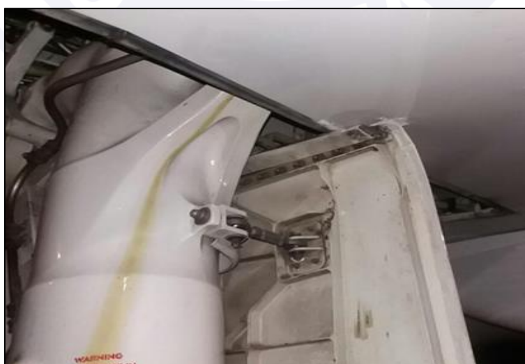
Figura 1 - Vazamento de fluido hidráulico no trem de pouso direito.
