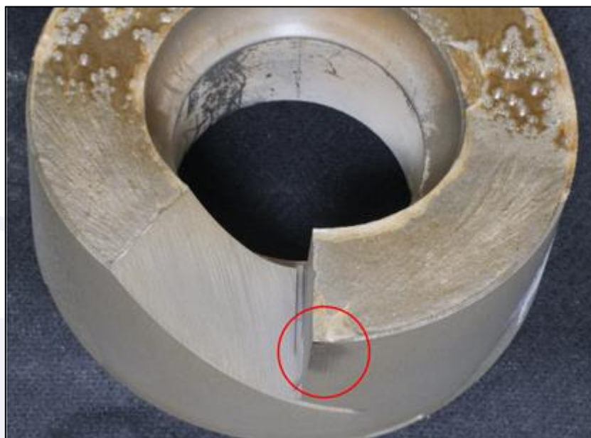
Figura 30 - Resultado da inspeção com Nital-Etch .
