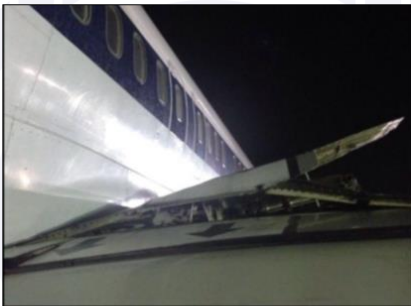
Figura 38 - Danos causados no extradorso da asa direita da aeronave VT-JGD em consequência da quebra do aft trunnion pin .
