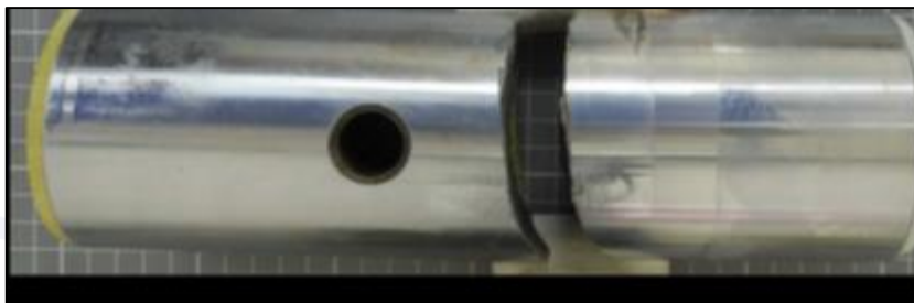
Figura 37 - Detalhe do aft trunnion pin SN 2430 fraturado que estava instalado no trem de pouso direito da aeronave VT-JGD.
