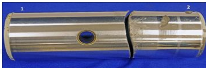
Figura 16 - Aft trunnion pin fraturado.
