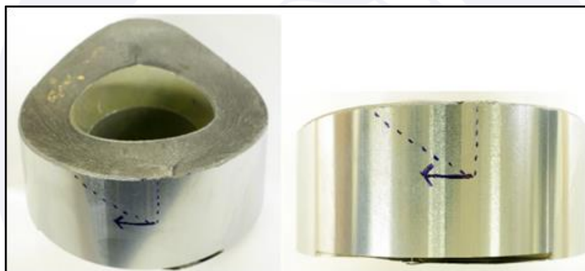
Figura 28 - Corte realizado para exames metalográficos.
