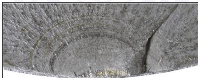
Figura 18 - Detalhe da fratura da parte 1 do aft trunnion pin .
