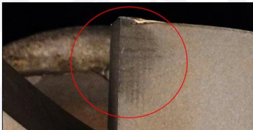
Figura 31 - Detalhe do resultado da inspeção com Nital-Etch .
