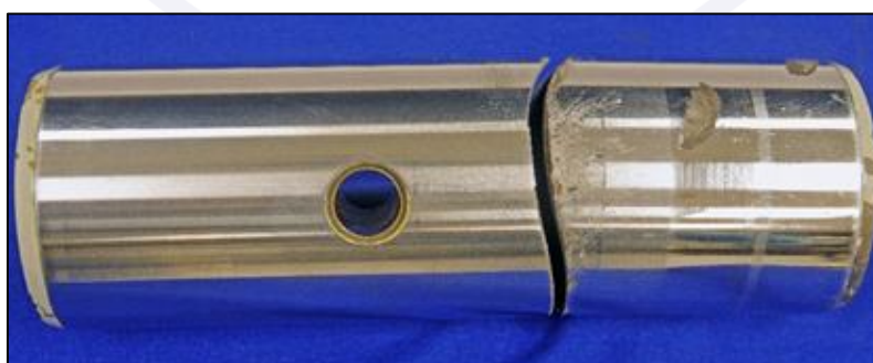
Figura 4 - aft trunnion pin fraturado.
