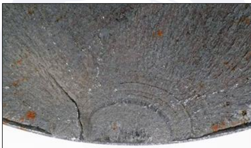
Figura 20 - Detalhe da fratura da parte 2 do aft trunnion pin .
