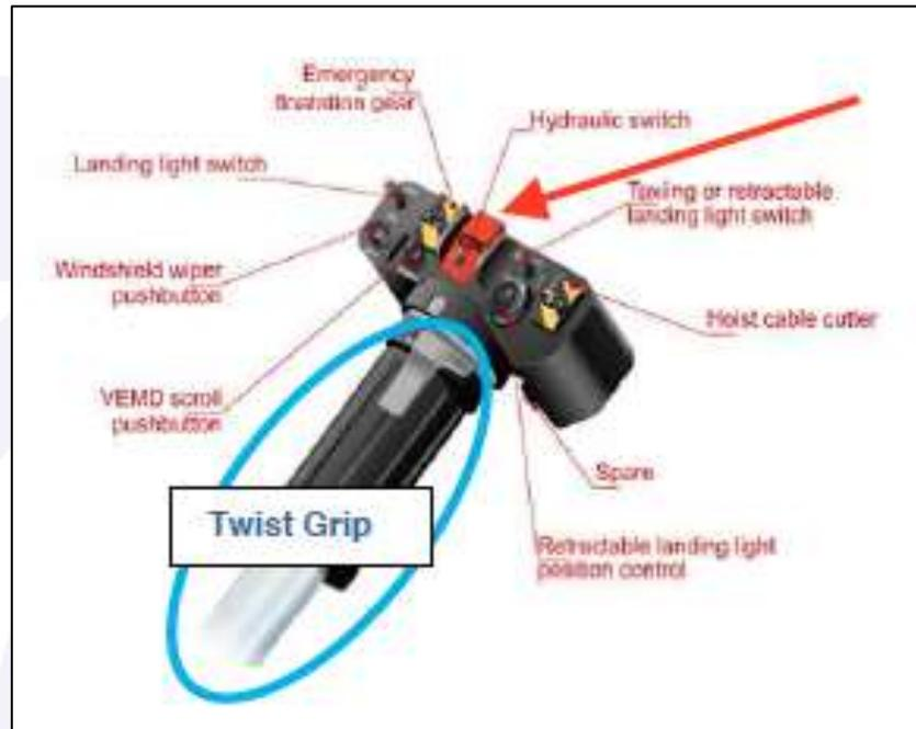
Figura 55 - Hydraulic Switch do comando coletivo.
