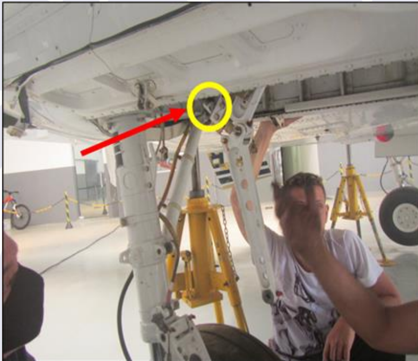
Figura 6 - Trem de pouso direito com a micro-switch destacada pelo círculo.
