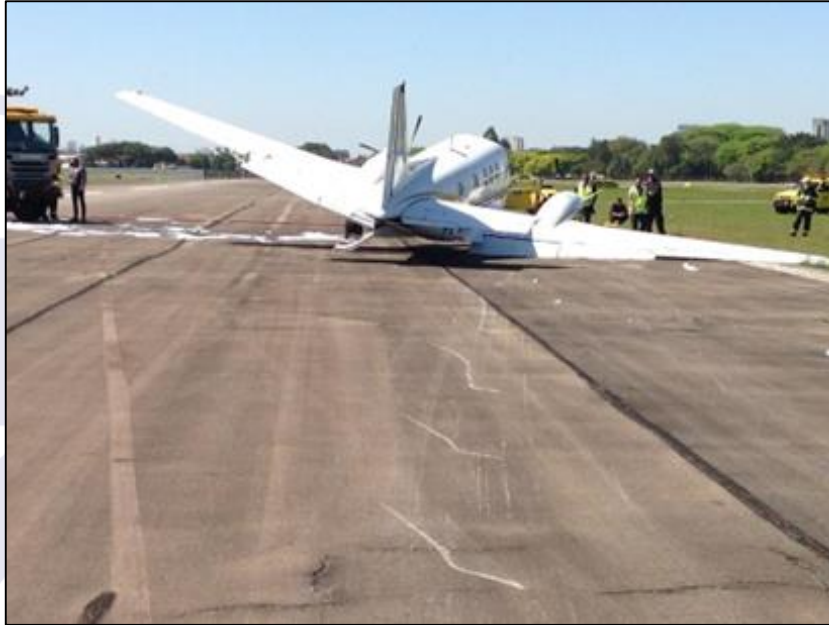
Figura 2 - Imagem da aeronave mostrando as marcas deixadas pela hélice na pista.
