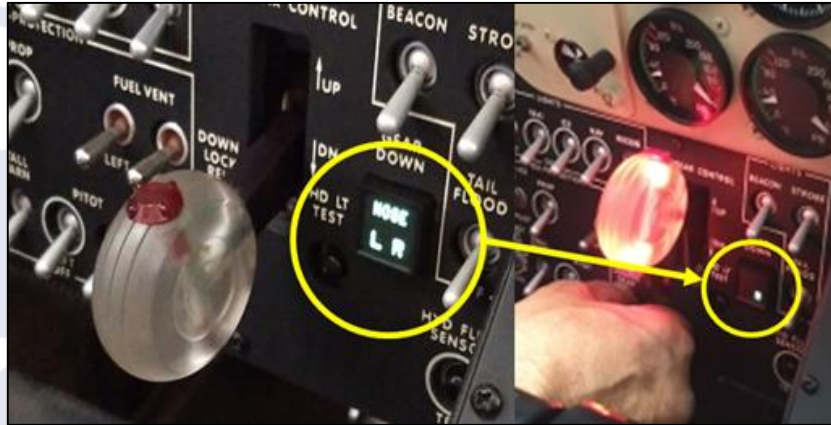
Figura 7 - Painel de indicação da posição dos trens de pouso. O círculo maior na figura mostra a condição das luzes com a alavanca em "DOWN" e o círculo menor mostra a luz "R" acesa durante a interrupção do ciclo de recolhimento.
