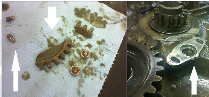
Figura 2 - Danos aos parafusos, engrenagem e base de fixação.
