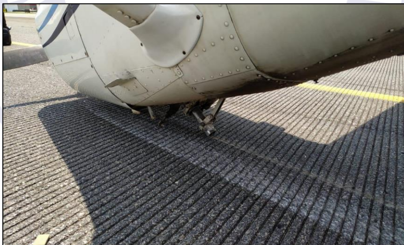
Figura 2 - Imagem do trem de pouso auxiliar quebrado.
