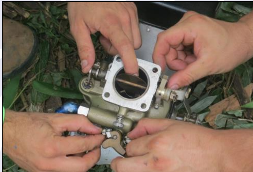
Figura 6 - Carburador do PR-EJO, com movimentos livres e sem combustível.
