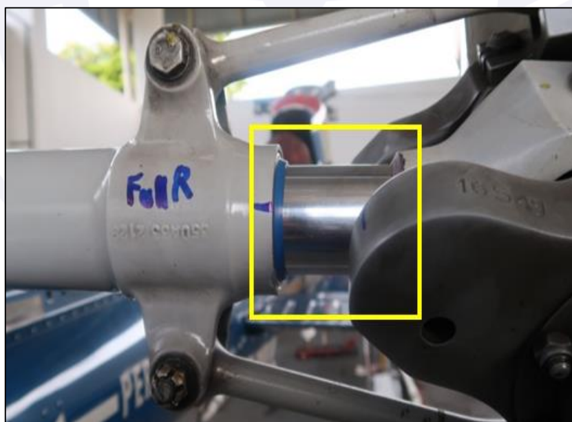
Figura 10 - Distância entre o contrapeso da pá do rotor de cauda e do prato rotativo com o pedal direito na posição fim de curso.
