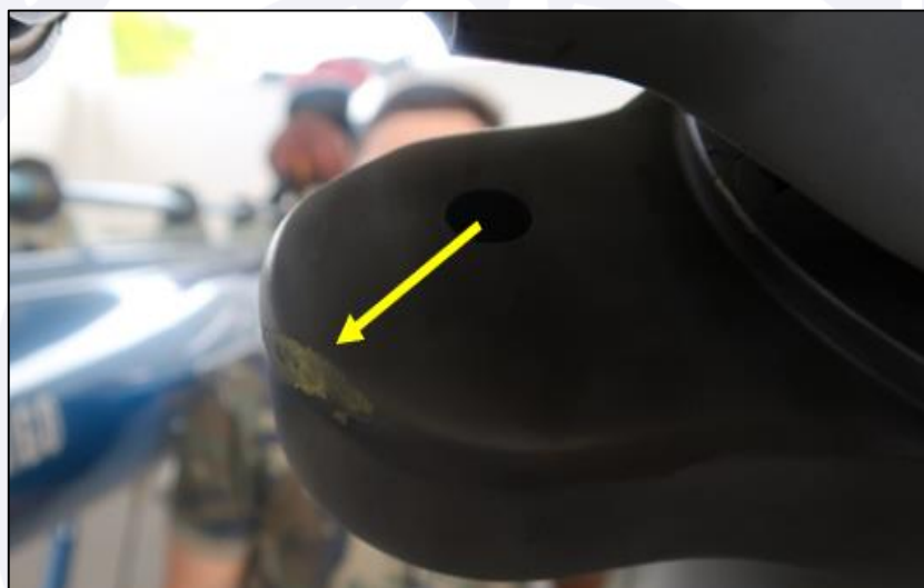
Figura 7 - Visão aproximada da marca deixada no contrapeso, em função do contato com o prato de controle rotativo.
