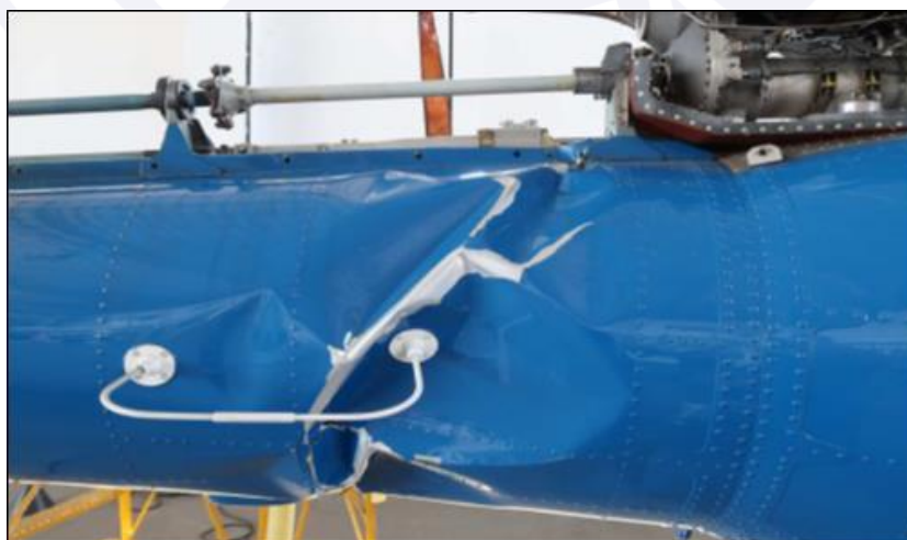
Figura 1 - Danos ao cone de cauda da aeronave (visto pelo lado direito).
