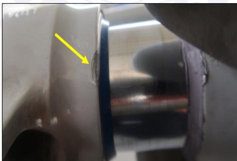
Figura 8 - Marca observada no prato de controle rotativo, ocasionada pelo contato do contrapeso da pá do rotor de cauda.
