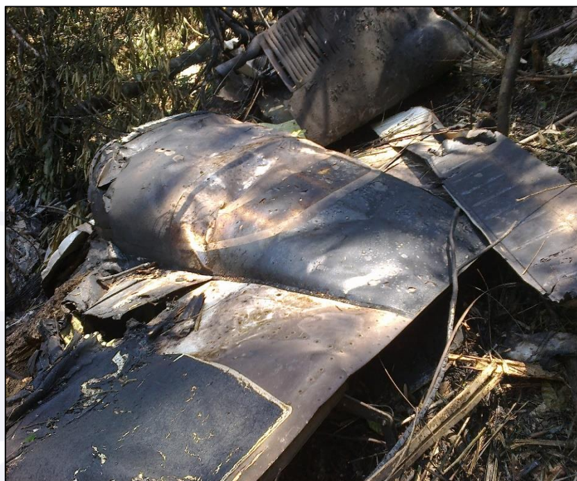
Figura 5 - Imagem de parte da asa direita e da nacele do motor. Fonte: Equipe de resgate.
