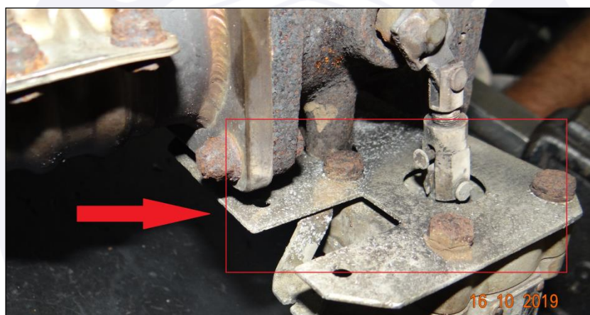
Figura 13 - Evidências do atuador atingido pelo vazamento de gases de escape do corpo da borboleta.
