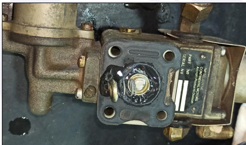
Figura 6 - Vista da desmontagem da bomba mecânica de combustível.
