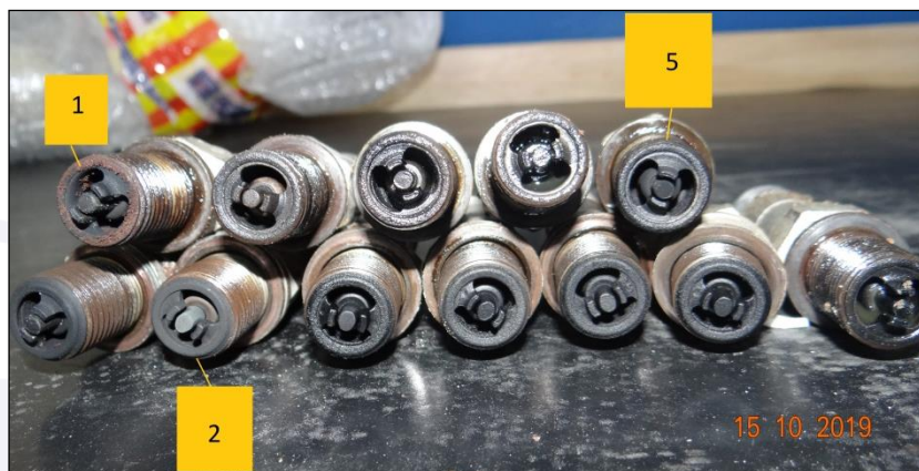
Figura 9 - Vista geral das velas de ignição do motor. Nas velas dos cilindros 1, 2 e 5 ficou evidente a presença de fuligem preta.
