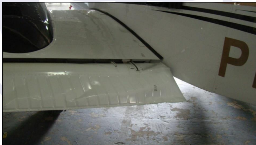
Figura 2 - Detalhe dos danos no flape esquerdo.
