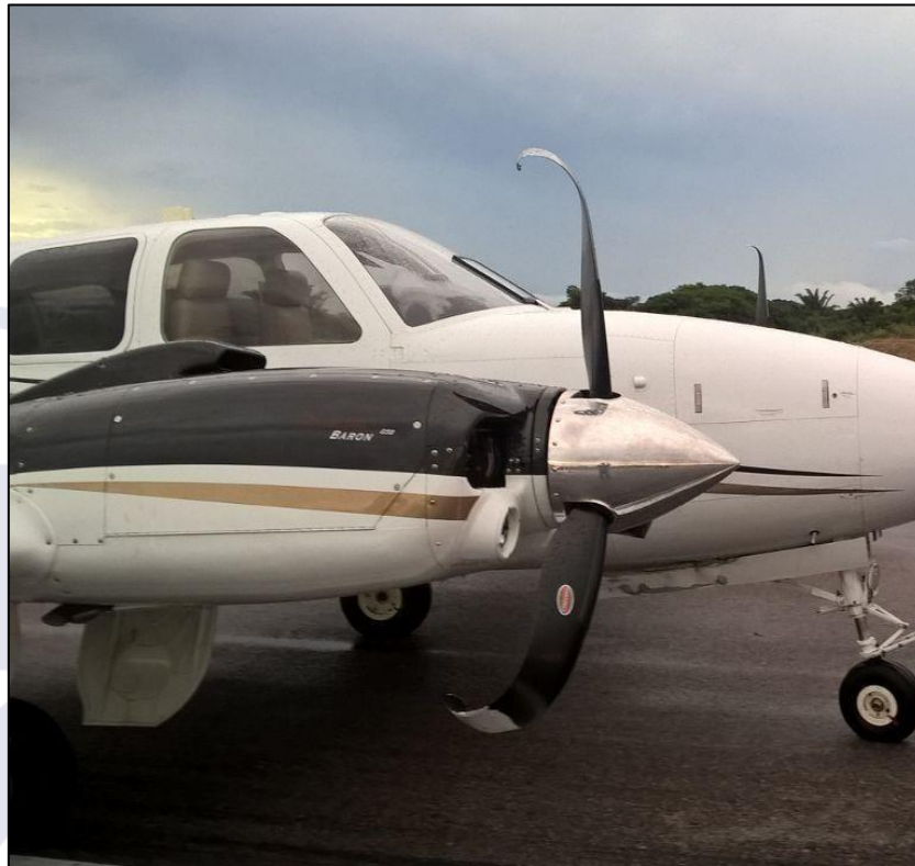
Figura 3 - Vista lateral direita mostrando os danos nas hélices.
