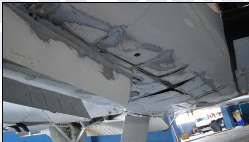
Figura 1 - Parte de baixo da fuselagem e porta do trem de pouso auxiliar.
