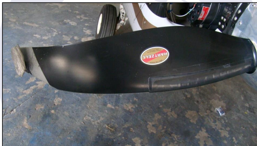
Figura 4 - Detalhe dos danos à hélice do motor esquerdo.
