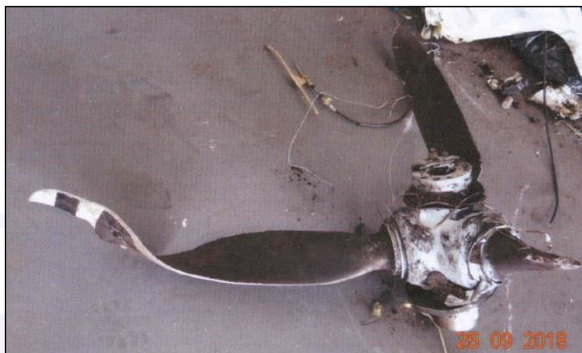
Figura 11 - Detalhe das fraturas e deformações nas três pás de hélice do motor esquerdo.
