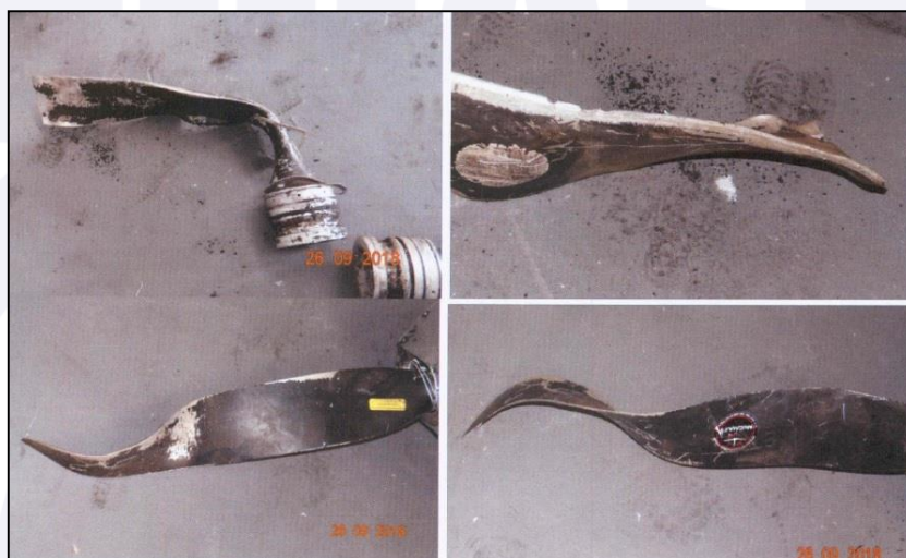
Figura 13 - Vista das pás da hélice direita com dobramentos voltados para frente.
