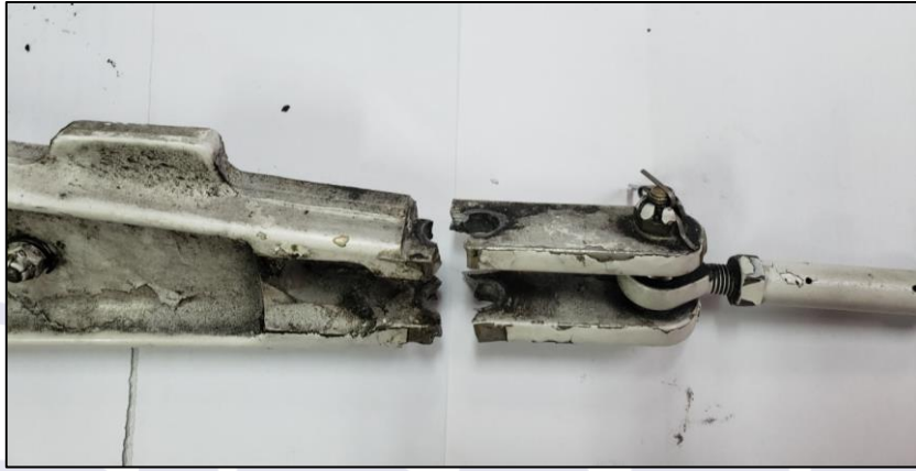
Figura 4 - Vista da fratura no Link Assy Landing Gear , PN: 75178-02.
