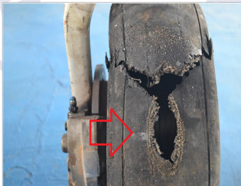
Figura 3 - Pneu esquerdo estourado.
