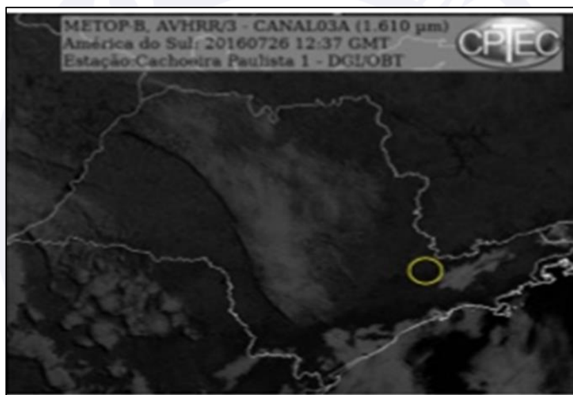
Figura 1 - Imagem na frequência visível sugere possibilidade de nuvens estratiformes na região em estudo.
