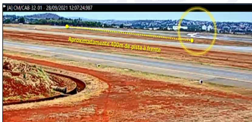
Figura 15 - Frame de vídeo da administradora do aeroporto, que permite visualizar a aeronave retornando ao solo, com aproximadamente 400 m de pista à frente.
