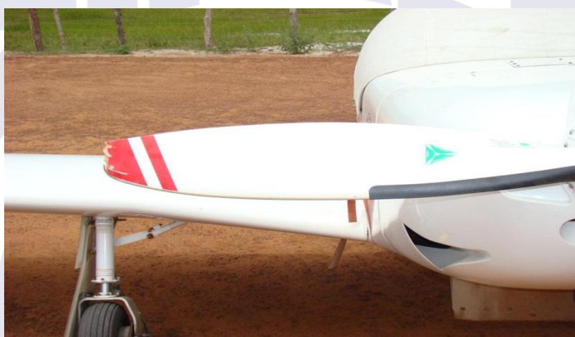
Figura 1 - Visão geral dos danos causados à ponta das pás da hélice.
