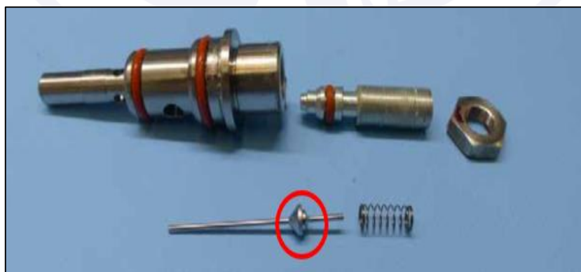
Figura 13 - Desmontagem da agulha da Unidade Controladora. Em destaque, local onde foram encontrados indícios de contaminação.
