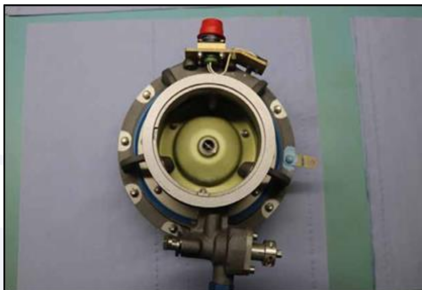
Figura 8 - Positive Relief Valve vista no sentido da seção externa, não pressurizada, da aeronave.
