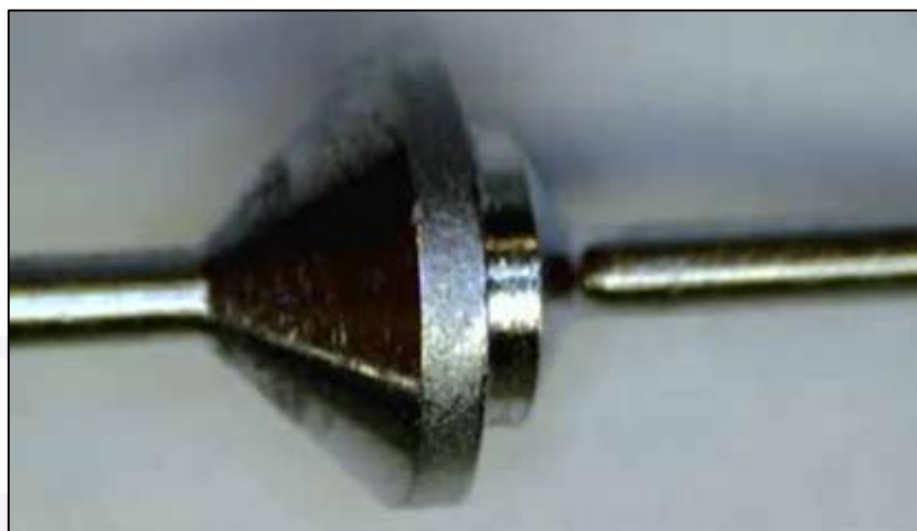
Figura 14 - Pequenos pontos de contaminação na parte interna da Unidade Controladora.
