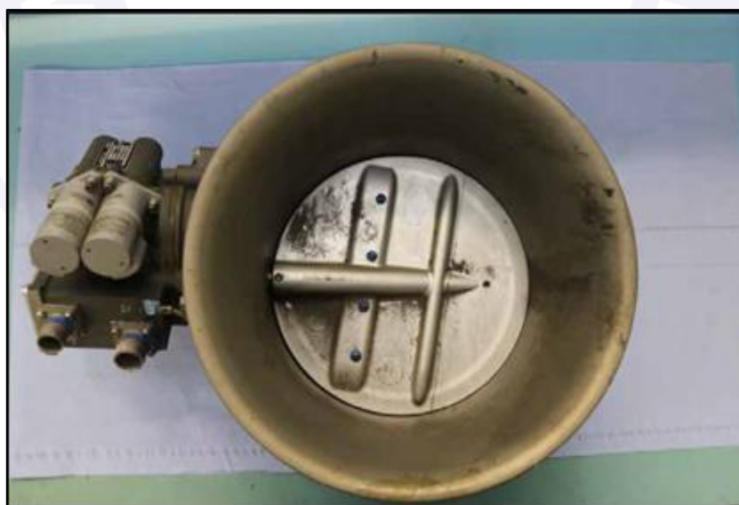
Figura 7 - Visão geral da Outflow Valve .
