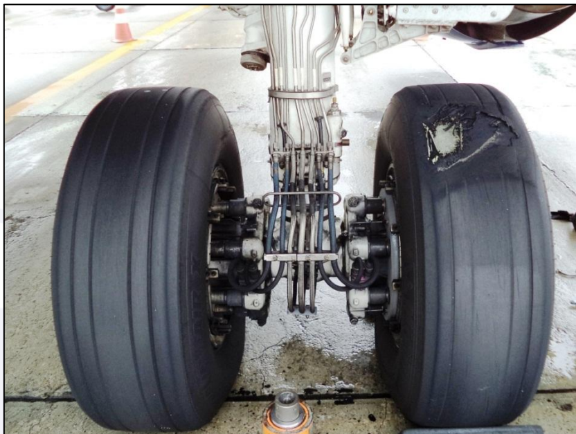
Figura 2 - Vista do trem de pouso principal direito, com o pneu direito danificado.
