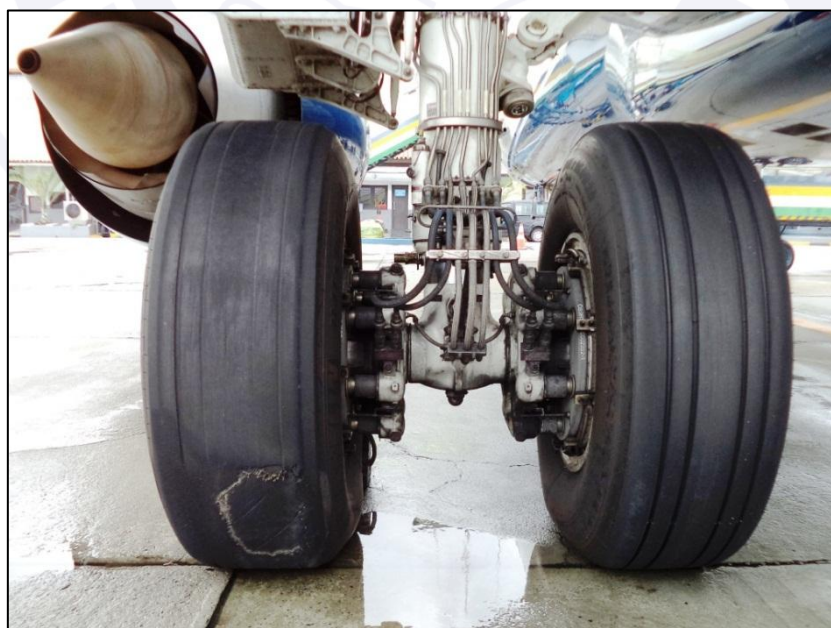
Figura 1 - Vista do trem de pouso principal esquerdo, com o pneu esquerdo danificado.
