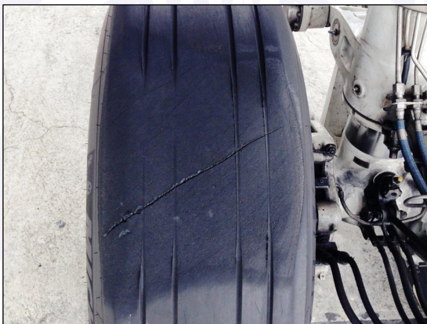
Figura 3 - Vista do trem de pouso principal direito, com o pneu esquerdo danificado.
